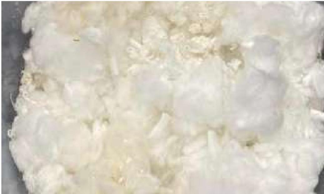
**01** Une fois que les filtres ont été dépollués et isolés à l'aide d'un système d'extraction, une mousse d'acétate de cellulose est obtenue, qui est une sorte de mousse plastique.
